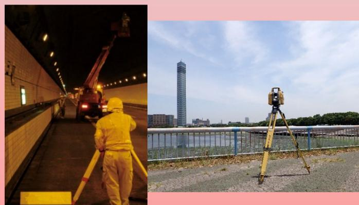
主に基準点測量・水準測量・地形測量・応用測量のことを指します。基準点測量は正確な位置(緯度,経度,標高)を求める測量、水準測量は標高の高低差を求める測量です。地形測量は自然地形や人工物の位置と形状を測定し、地名や境界などを調査する測量で、地形図の作成に用いられます。応用測量は基準点・水準・地形測量の知識や技法を応用して作業する測量で、道路や河川、トンネル等の計画や設計管理等に用いられます。
